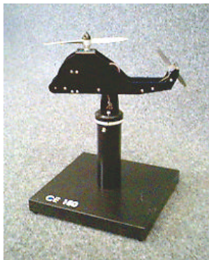
Figura 2: Il simulatore di elicottero Humusoft CE150.
