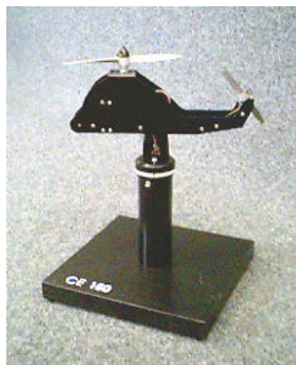
Figura 2: Il simulatore di elicottero Humusoft CE150.
